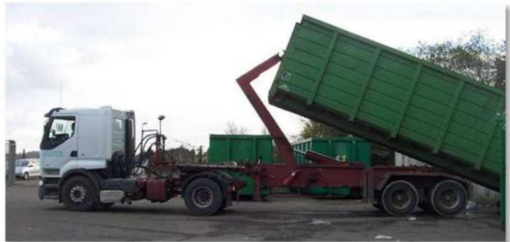
**3. Vidage gravitaire dans une trémie compactrice et caissons amovibles**
