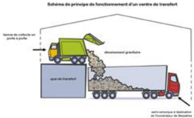
Ce type de transfert est bien adapté aux déchets denses tels que les OM, les déchets verts ou les gravats. En revanche, les déchets à faible densité, ayant un faible poids et occupant un grand volume, ne permettent pas de charger les véhicules de transport aval (gros porteurs) au maximum de leur capacité (technique ou réglementaire).
